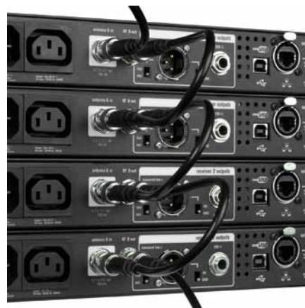
Die Durchschleifmöglichkeit des HF-Signals ermöglicht den Betrieb von bis zu 10 Empfängern der gleichen Frequenzversion.
